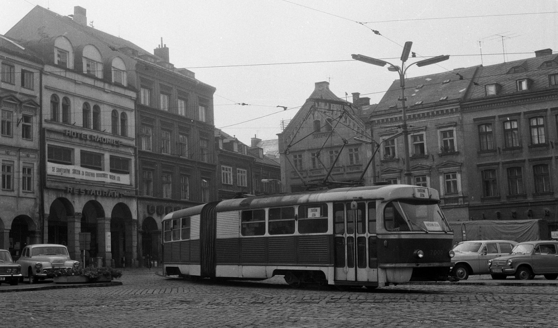
„První vůz“ KT4 v Liberci. Funkční vzorek vznikl přestavbou prototypu tramvaje typu K1 a v Liberci byl testován v roce 1972. Cestující však nikdy nevozil. (foto: Erwin Cettineo)
