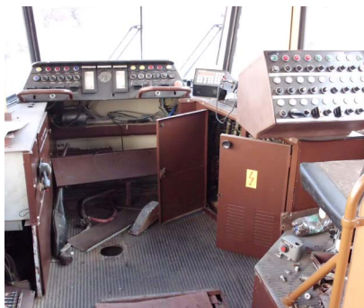
Stanoviště řidiče s pultem instruktura ve voze KT4D. (foto: Michal Chrást)
