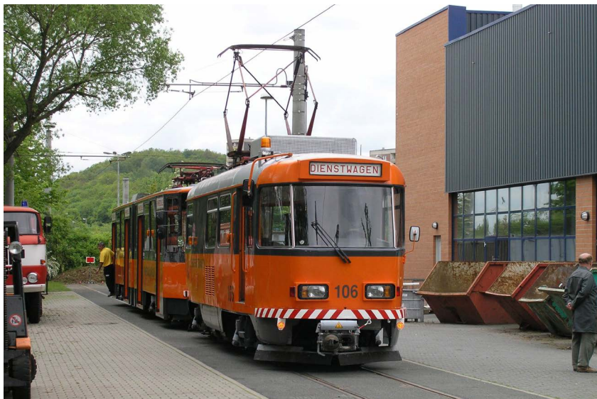
Příprava přepravy tramvaje KT4D do Liberce. Pro posun vozidla byl využit služební vůz ev. č. 106 vzniklý přestavbou tramvaje T4D původem z Drážďan. Přestavbu realizovaly dílny pražského DP v roce 1992. (foto: Jiří Hrbek)
