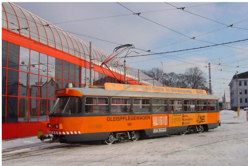
Brousicí vůz T4D původem z Gery na zhlaví vozovny v Liberci. (foto: Jiří Hrbek)
