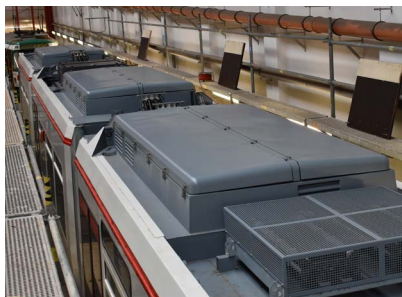
Nové trakční měniče CAC 018N NF od Cegelecu byly ukryty do starších kontejnerů, což minimalizovalo zásah do konstrukce vozidla. (foto: Libor Hinčiča)
