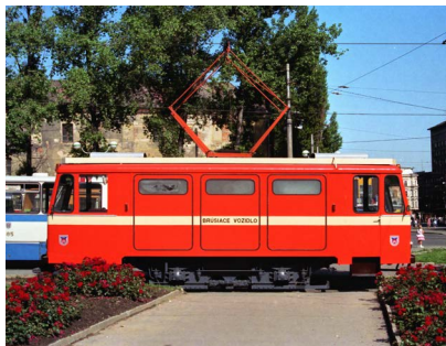
Skříňné brousicích vozů Schörling měly v podstatě unifikovanou konstrukci. Fotografie z roku 1992 nabízí pohled na typickou bočnici vozu ve smyčce Fügnerova. (foto: Tomáš Krebs)
